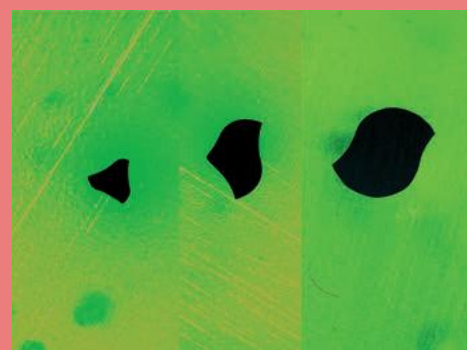
Εικόνα 1. Σχήμα της διατομής του εργαλείου OneShape που μεταβάλλεται από τρεις κοπτικές ακμές στην άκρη (αριστερά) σε δύο στη βάση του εργαλείου (δεξιά). [4]
