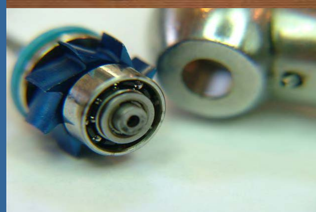
Εικ.1: Τύποι κεραμικών ρουλεμάν και φτερωτή συναρμολογημένη
