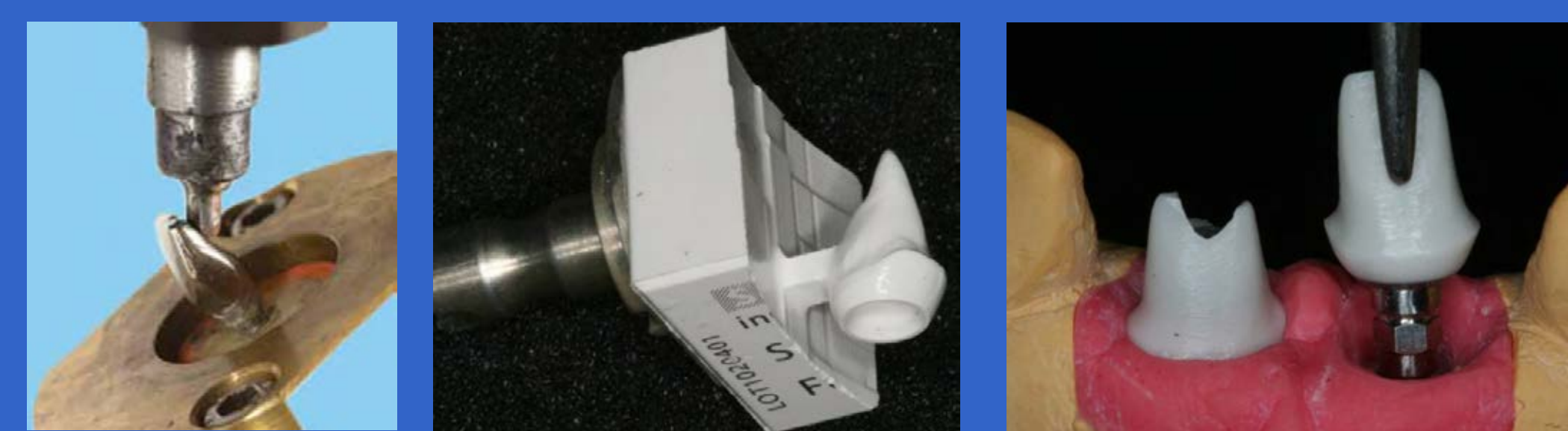
Εικόνα 6. Κατασκευή του στηρίγματος από κοπτικό μηχάνημα CAM (computer-aided manufacturing).
